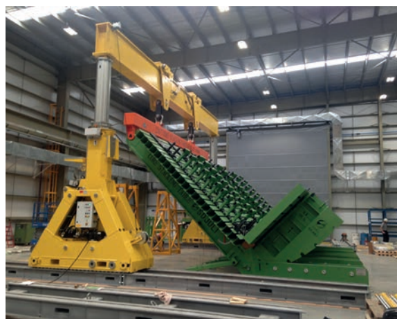
A estrutura se usa como suporte para montar o núcleo do transformador elétrico. Precisa ser posicionado em ângulos específicos para montagem.
