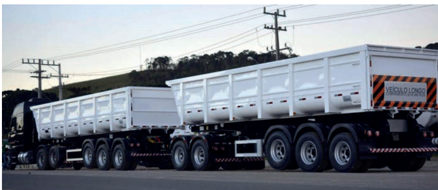
Um CVC tem peso bruto total combinado de entre 74 e 91 toneladas, altura de até 4,4 metros e comprimento mínimo de entre 28 e 30 metros.
