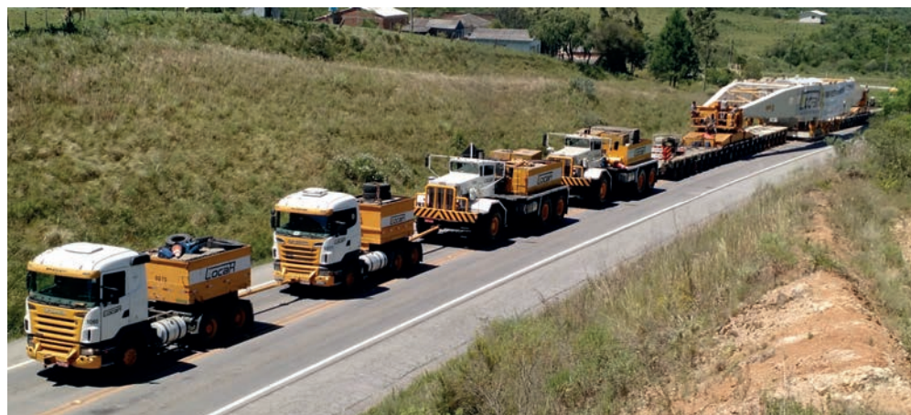
A Locar transportou um gerador de 12,61 metros de comprimento, 4,51 metros de largura e 4,04 metros de altura, com peso de 361 toneladas, por cerca de 170 km.
