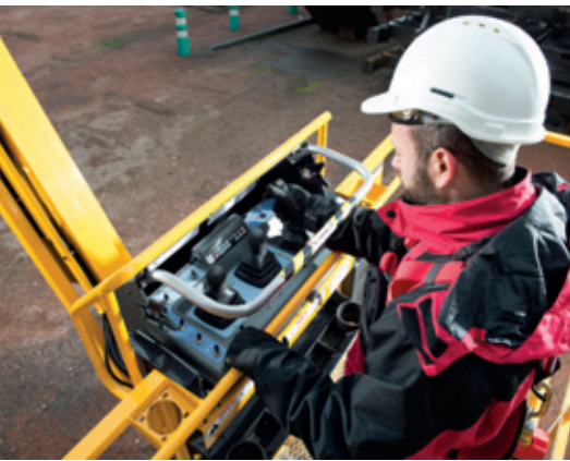
O Activ'Shield Bar 2.0 da Haulotte é o sistema de proteção do operador integrado na cobertura do posto de controle superior.
