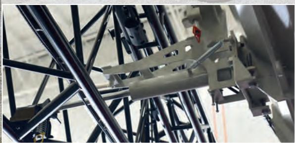
O sistema de intertravamento do jib garante a operação correta. Os parafusos de ajuste de velocidade da cabeça da lança permitem uma montagem/desmontagem simples e eficiente.
