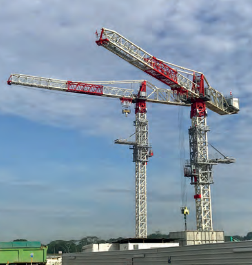
Um Jaso J1400s pronto para o trabalho com pré-fabricados volumétricos em Cingapura.
