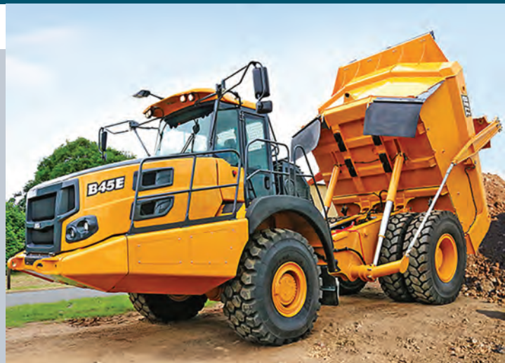
O B45E da Bell Equipment tem novo design oscilante do chassi e pneus mais elevados.
