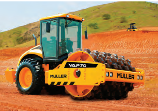
A Müller sempre foi conhecida por seus rolos compactadores, como o modelo VAP 70.
