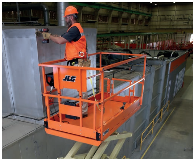
A 3246R conta com altura de plataforma de 9,75 metros.
