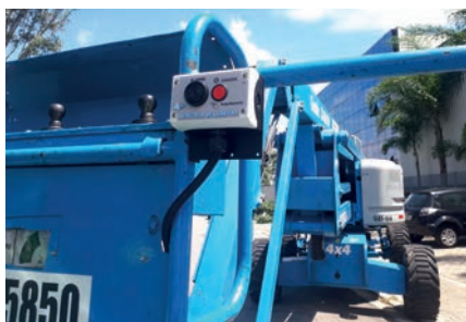
O alarme de aproximação à linha elétrica fica perto do operador.
