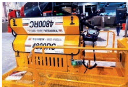
Terex Bid-Well apresentou controle remoto para pavimentação.
