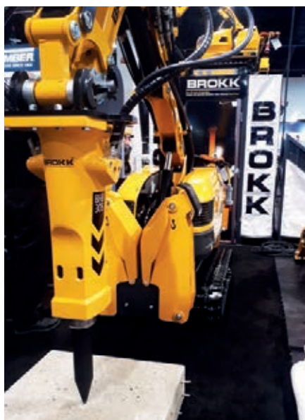
Os robôs de demolição controlada são uma parte muito interessante do que sempre há na grande feira do concreto.
