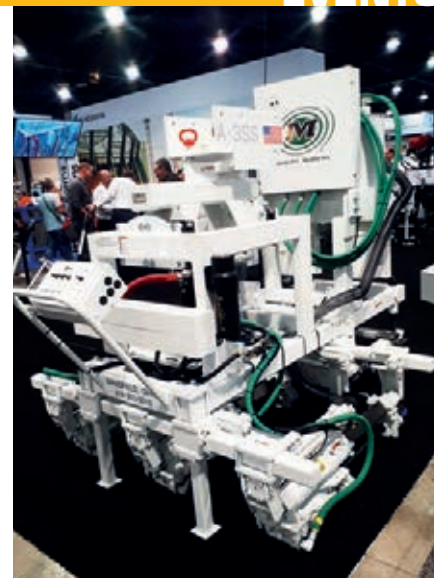
Os equipamentos da Minnich são líderes na perfuração lateral de pavimentos para introdução de barras.
