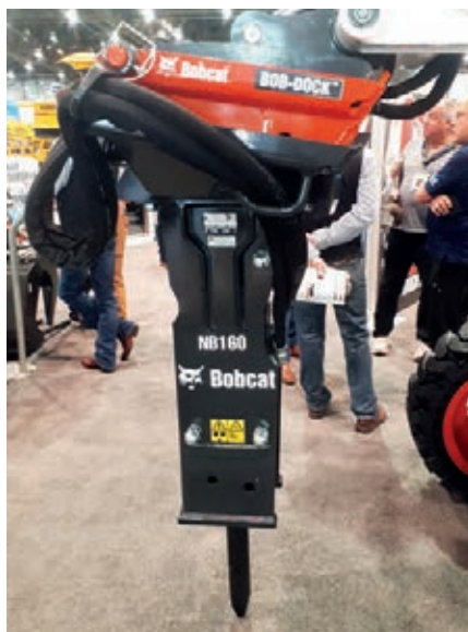
A Bobcat apresentou seu Bob-Tach, para conexão de implementos com mais segurança para mangueiras hidráulicas (parte vermelha sobre o martelo).
