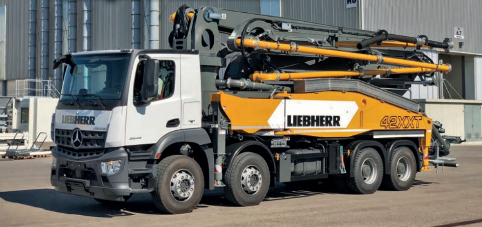
A nova 42 M5 XXT da Liebherr concentra os elementos de medição e comutação hidráulica no sistema Powerbloc.
