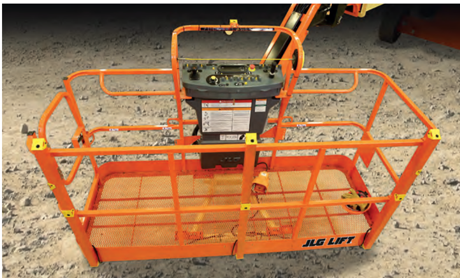
O EDS é um sistema da JLG que prevê contato com objetos ou estruturas.
